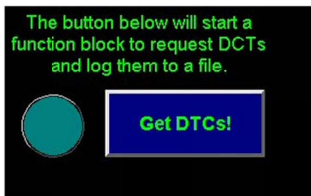
图 2-55 HS CAN 总线上向所有电控单元发送请求故障码的图形面板完成示例
